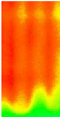
Fig. 13: Campo termico nella zona inferiore del pannello caldo, in corrispondenza delle curve nella serpentina.
