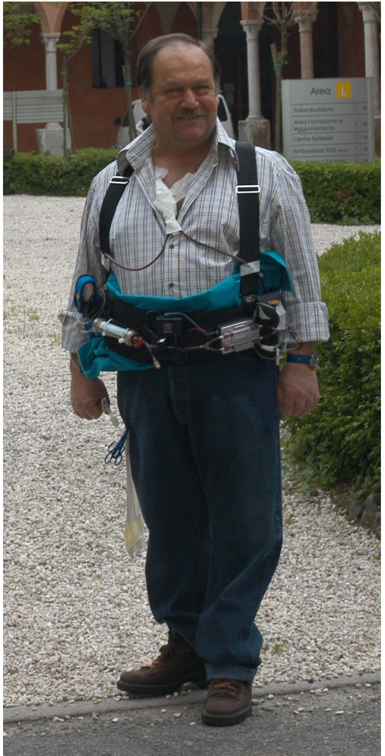
Il prototipo della cintura in funzione durante la dialisi
